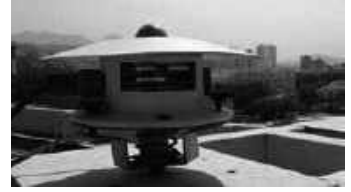
شكل (٢): صورة مجمعة وتفصيلية لأجهزة رصد الإشعاع الشمسي الكلي وتحت الحمراء وفوق البنفسجي بمحطة العزيزية.
