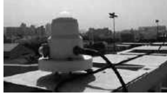
شكل (٢): صورة مجمعة وتفصيلية لأجهزة رصد الإشعاع الشمسي الكلي وتحت الحمراء وفوق البنفسجي بمحطة العزيزية.
