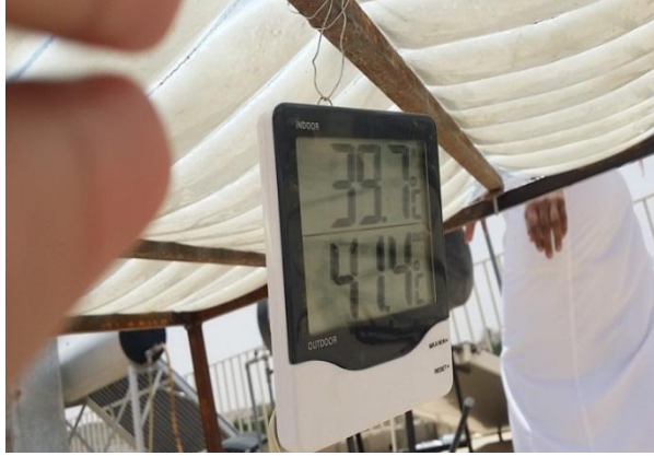
شكل رقم (٤) أجهزة لقياس الحرارة داخل وخارج نماذج الخيام المصممة
