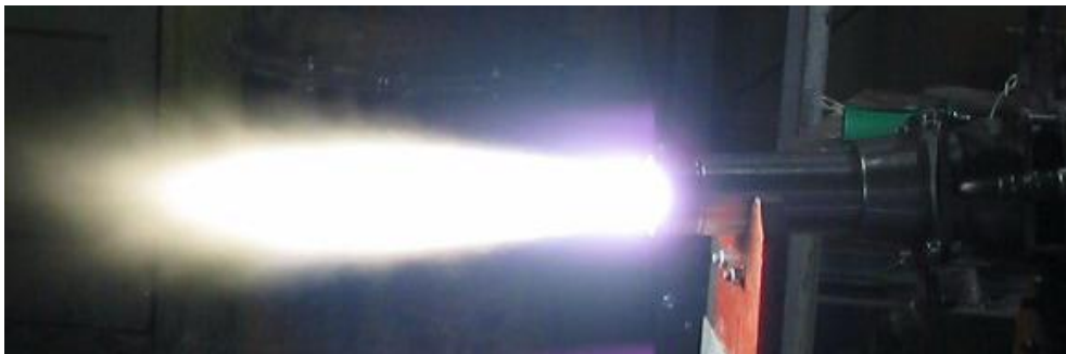
شكل (١٠) يوضح مدفع البلازما ٢٥٠ كيلووات ذو التيار المتردد المستخدم لعملية التغويز في فرن البلازما
