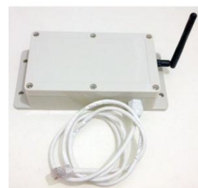
شكل-٣: الإسورة الذكية للحاج، وقاري للشرائح الراديوية الفعالة عن بعد يصل إلى ٢٠ متر (مثلاً: موديل VT-20R Active RFID Network Reader)
