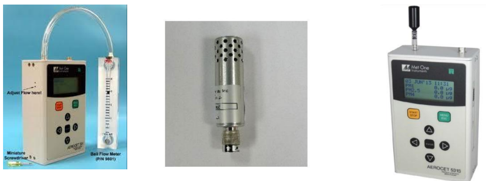
شكل (٤): جهاز قياس الأتربة المستنشقة بجميع أحجامها مع جهاز المعايرة.
