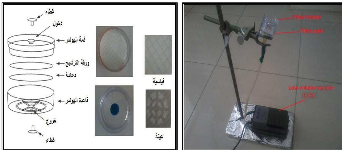
شكل (٢): جهاز تجميع عينات الأتربة الصخرية ( $PM_{10}$ ).
