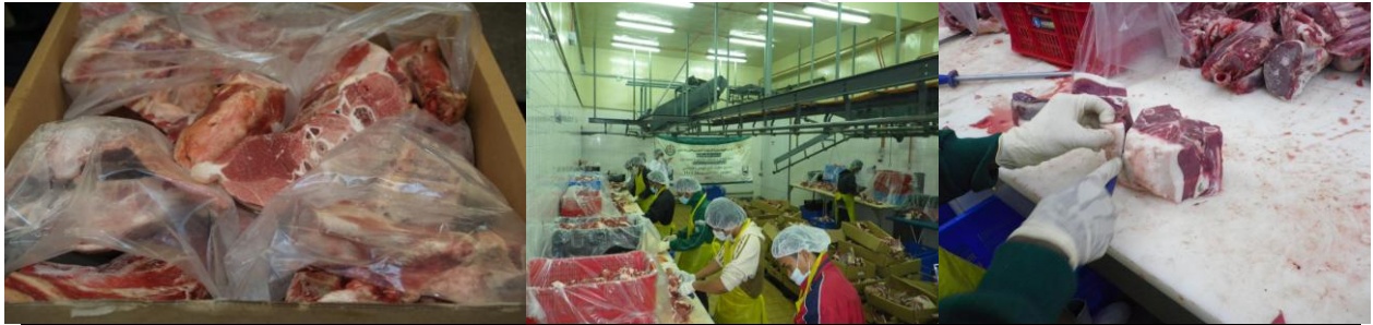
شكل رقم (٤) لحوم الأضاحي المجمدة في غرفة فصل اللحم عن العظم شكل رقم (٥) وحدة فصل اللحم عن العظم . درجة الحرارة ٢-٤ درجة مئوية شكل رقم (٦) عملية فصل اللحم عن العظم.
