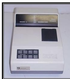
شكل (٤): جهاز التحليل الطيفي Pharmacia LKB Novaspec II UV/VIS Spectrophotometer
