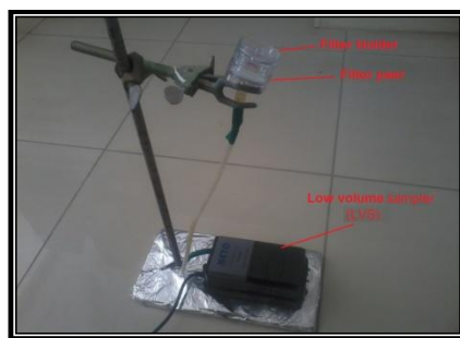
شكل (٣): جهاز تجميع عينات الأتربة المستنشقة (PM 10 )
